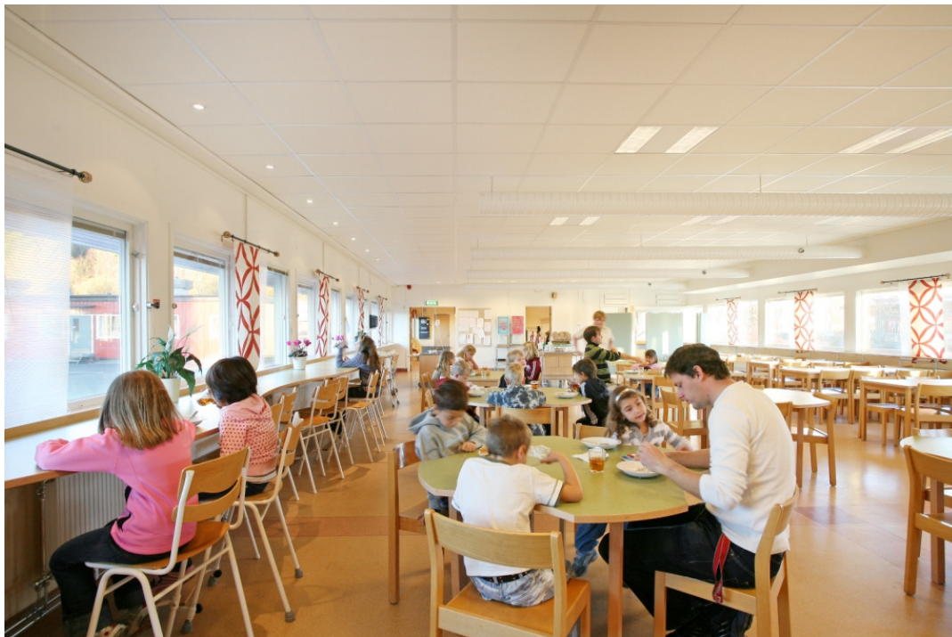
Matsalen efter åtgärder: Genom att skolapparaterna togs bort och ersattes med vattenburna radiatorer blev det plats för en populär sittbänk och "bardisk" med mjukt rundade former längs med fönsterraden.
